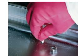
Placer le gicleur dans le liquide détartrant et laisser agir (gicleur doit être exempt de calcaire)
